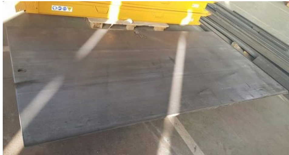
Imatge 5. Mostra de placa de ferro per a cobertura de rases apta per al pas de vehicles.
